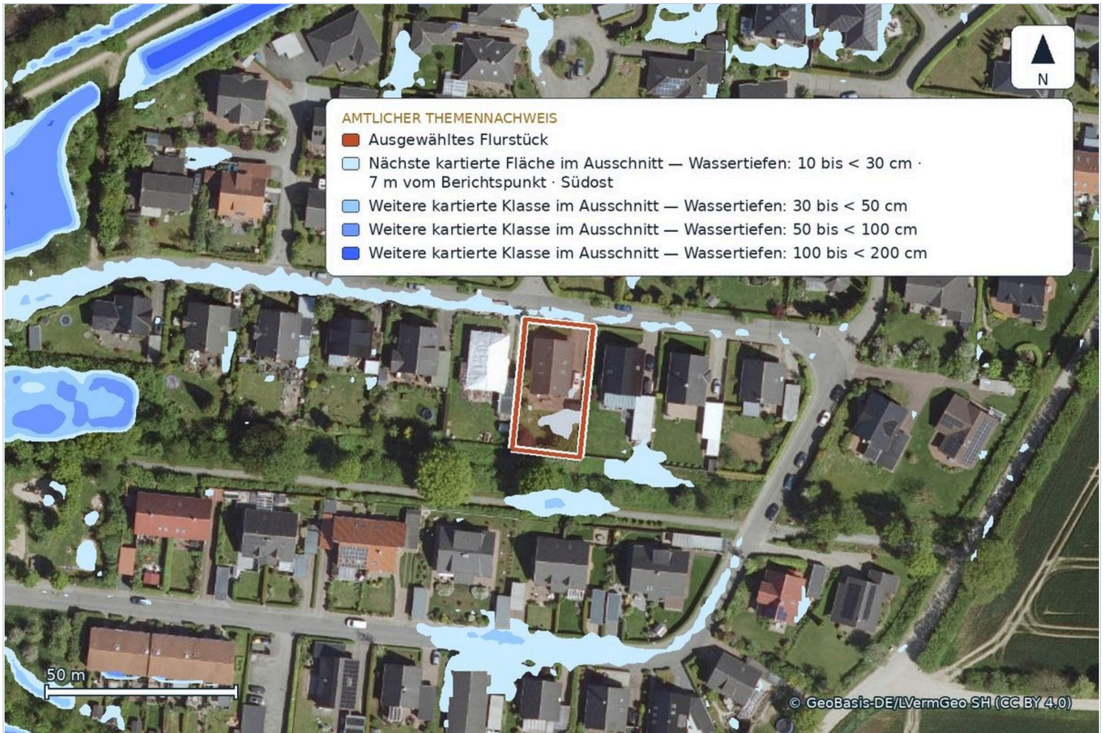
ABB. 6.3 – Starkregen (BKG) BKG · Starkregen-Hinweiskarte · Überflutungstiefe.
